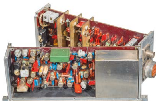
Prvním přístrojem určeným pro práci na palubě družice, který byl v ionosférickém oddělení Geofyzikálního ústavu ČSAV vyvinut, byl telemetrický vysílač pro družici Interkosmos 3 z roku 1970. Foto: M. Frouz
