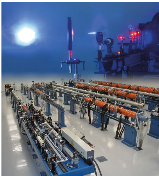
Obr. 12 Laserová jiskra ve vzduchu při fokusaci jodidového laseru PALS (Prague Asterix Laser System). Foto: Archiv S. Civiše
